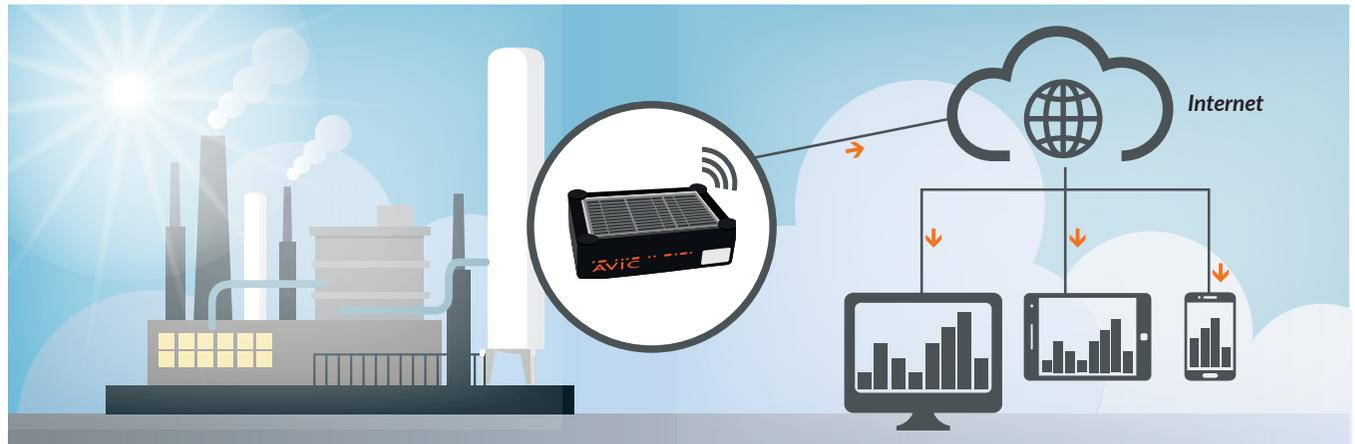
*La información sobre el nivel del tanque se envía al centro de datos con ayuda del hardware LegioBox y la comunicación de datos móviles*
