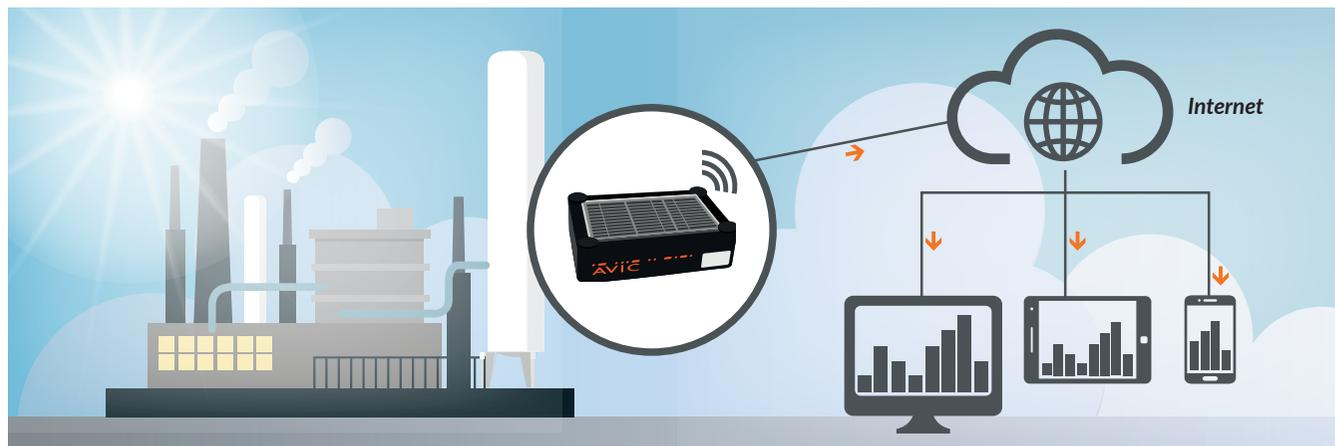
*L'information relative au niveau du réservoir est envoyée à l'aide du LegioBox hardware et de la communication mobile au centre de données*
